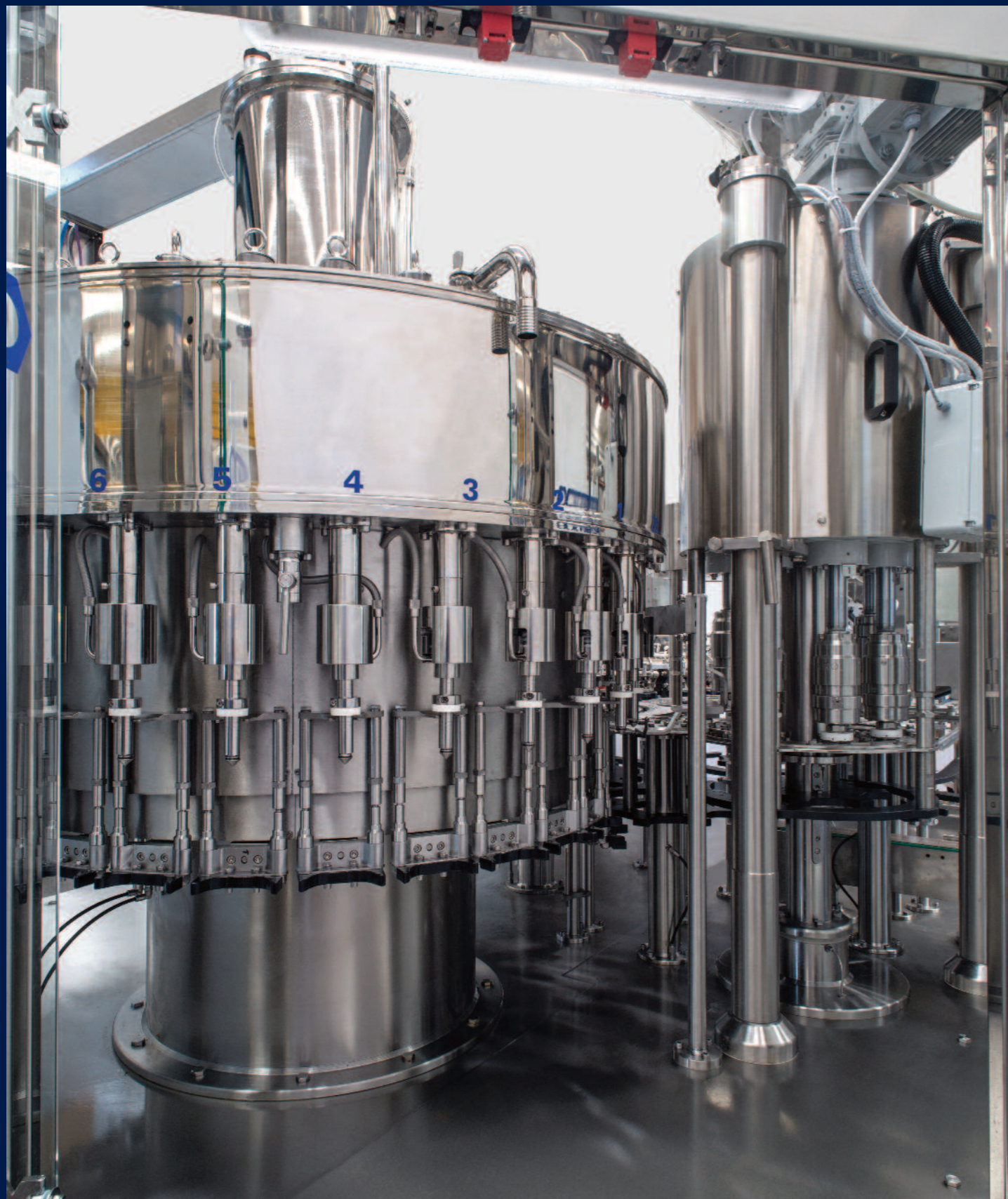
MONOBLOCCO RIEMPITRICE IPERBARICA (leggera pressione) prodotta con valvole a funzionamento meccanico o a funzionamento elettronico (elettropneumatico)
