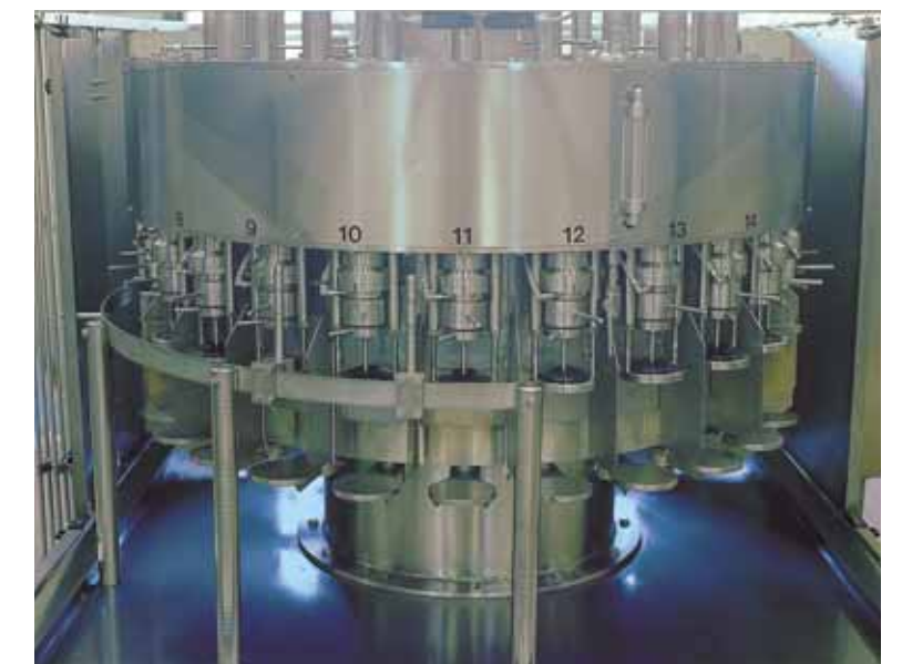
Lado superior y lado frontal del deposito anular de llenado al centro el pulmón de sostén.
