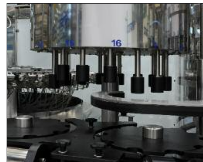
Torretta Deox a 16 teste con tunnel di protezione a gas inerte tra la Deox e la riempitrice Deox turret a 16 heads with inert gas protection tunnel between Deox and filter
